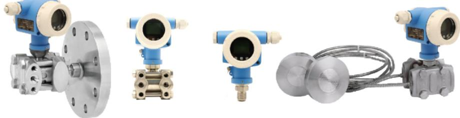
PK系列变送器主要由测压元件传感器（也称作压力传感器）、测量电路和过程连接件三部分组成。它能将测压元件传感器感受到的气体、液体等物理压力参数转变成标准的电信号(如4....20mA DC等)，以供给指示报警仪、记录仪、调节器等二次仪表进行测量、指示和过程调节。
